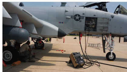
图3 基于PXI的加固测试系统确保飞行线的任务准备就绪
