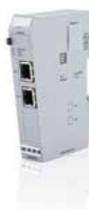
B-NIMISM2-2端口扩展器 该扩展器用于使用没有 MC 格式的 附加 EtherCAT设备来扩展 E-I/O块。扩展器将传输物理从 (LVDS)转换为双绞线以太网
