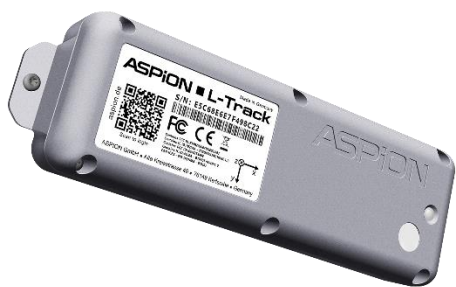
ASPiON L-Track IoT 数据记录器 用于安装在运输货物上
